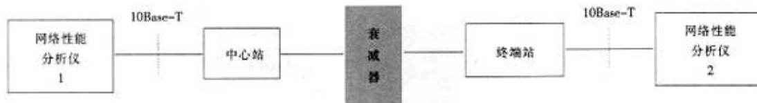
图 17 端口吞吐量测试配置
